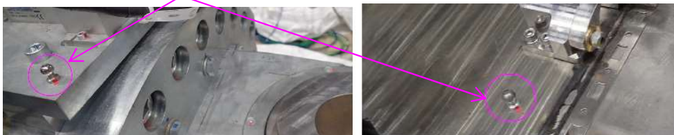
アームに設置されたボールスタッド
