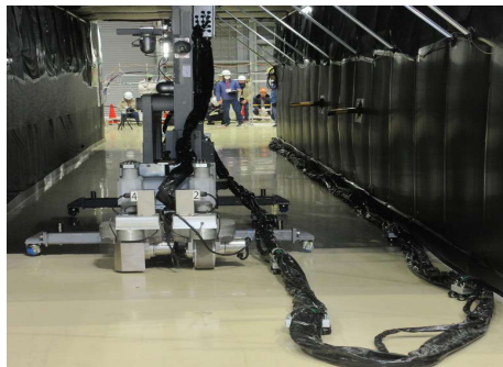
追設遮蔽板装置遠隔運搬
