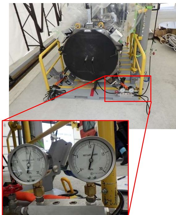
X-6ペネ接続構造装置 気密確認
