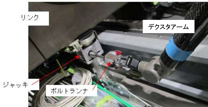
ジャッキの下降操作
